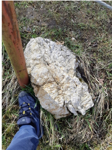
Slika 3 Skalni blok za objektom Partizanska pot 7. Dimenzije 0,6x0,35x0,25 m – 140 kg (številka 1)
